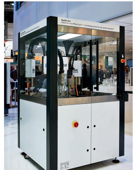
**Bild 1.** Die kompakte Plasma Treatment Unit kann auf den bisher üblichen Sechachsroboter und zusätzliche Linearachsen verzichten
