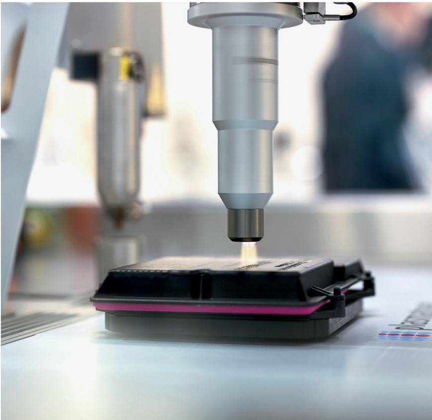
Ein schwebender Planarmover bewegt das zu bearbeitende Werkstück; die Plasmadüse ist fest montiert © Plasmatrete, Jan Dufelsiek
